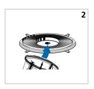
Vorbehandelte Restfläche (mit z.B. verdünntem Styropor-Kleber als Primer) zwischen Betondecke und Ausschnitt ausspachteln oder verputzen. Anschließend Leuchtenmontage.
